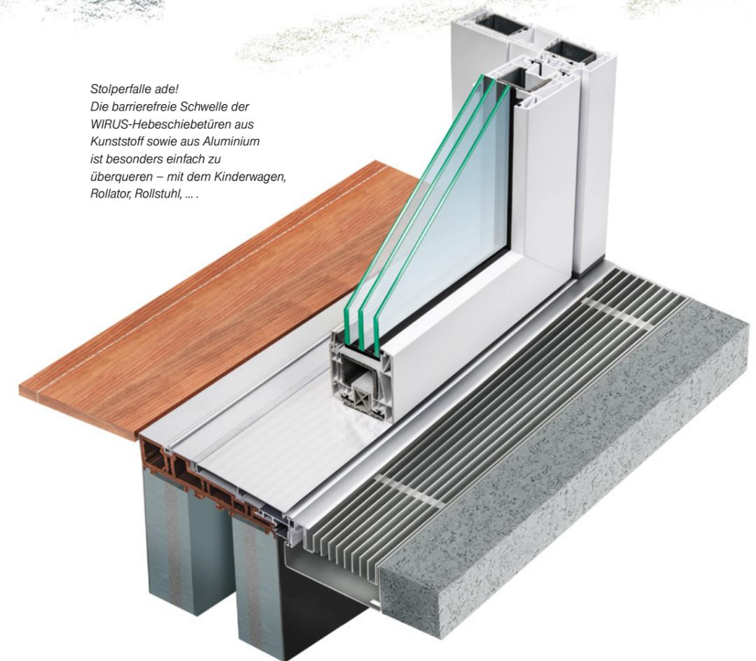
*Abb.: Einbausituation schematisch HST 82
